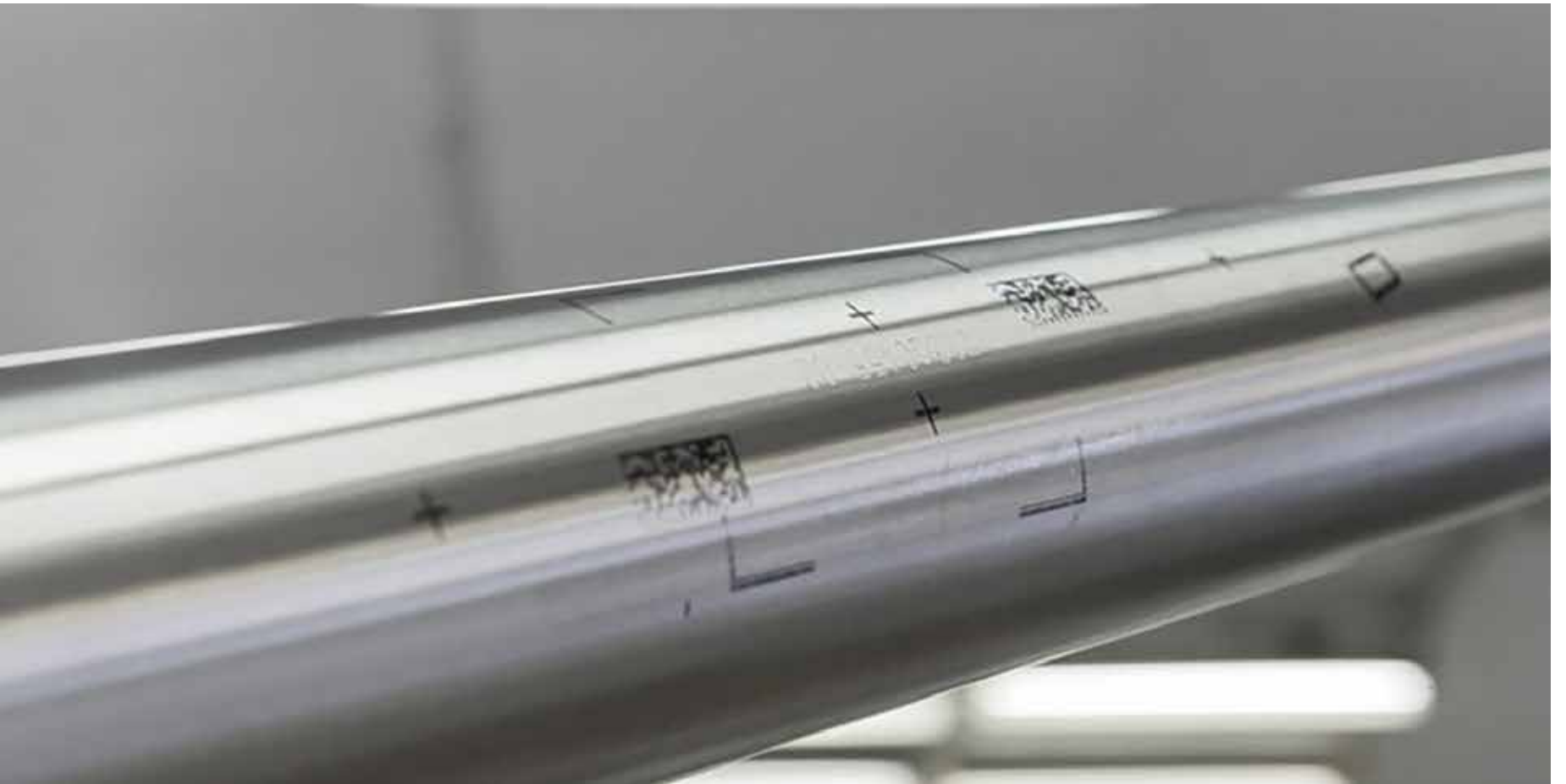
يملك كل أنبوب من الأنابيب الفولاذية، التي يبلغ عددها 75 ألف، رمزًا مميزًا؛ لتحديد موقعه في المبنى بدقة.
